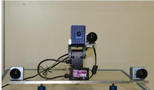
Abb. 2: Multikamera-Aufbau mit Stereo-Farbkamera, Fischaugenkamera, sowie Z-Kamera auf Schwenk-Neige-Einheit.
