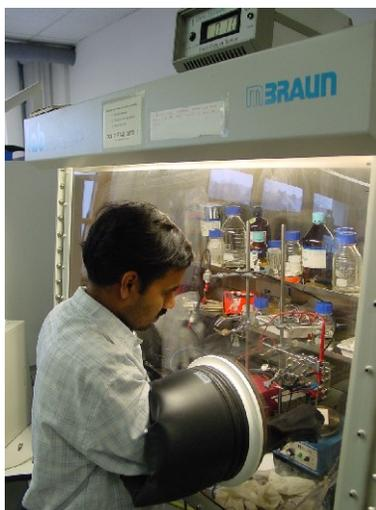
Abb. 1: Herstellung und Charakterisierung neuer fester Lithium-Ionenleiter in Handschuhkästen mit Argon-Schutzgas-Atmosphäre
