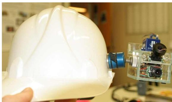
Abb. 1: Kamerasystem mit Fischaugenkamera, Frontkamera, sowie 3D-Orientierungssensor, montiert auf einem Bauhelm.
