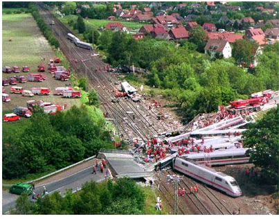
Die Folge eines gebrochenen Radreifens
